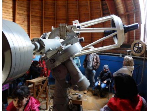
Телескоп ВАУ для наблюдения ИСЗ и космического мусора
